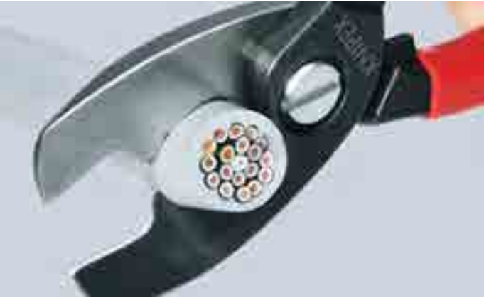
最终剪切：然后再用靠近铰接轴的后剪切刃口进行剪切，只需花很小的力气。初始剪切用前剪切口，最终剪切用后剪切口。
