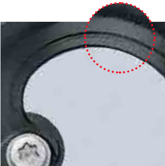
精密研磨并感应硬化的刃口
