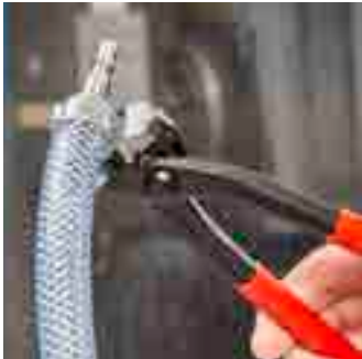
利用侧边钳口密封快速连接器上的空气软管
