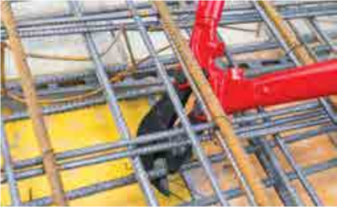
剪切钳头的特殊形状设计，使得 71 82 950方便剪切平放的建筑钢筋
