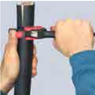
转动工具进行环绕切割
