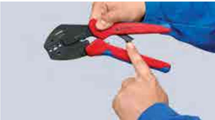
把定位杠杆折叠到手柄内，工具准备完成
