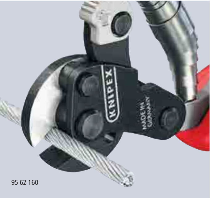
用于剪切高强度钢丝绳 (1960 N/ mm²) 最大直径达4 mm
