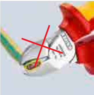
用斜口钳剪切电缆: 费力, 不精密, 对线缆造成相当大的变形和挤压
