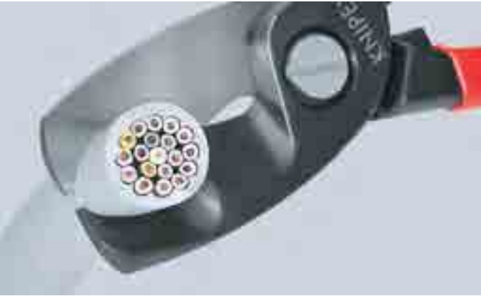
初始剪切：在剪切直径相对较大的电缆时，先采用前刃口进行剪切，保证手柄最大限度打开
