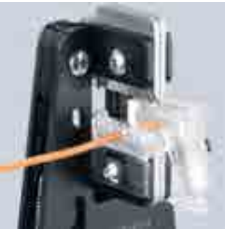
12 12 02 带电缆导槽和长度定位器
