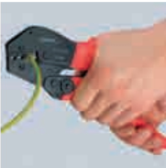
工具的反馈力度使单手力量不足使继续操作时，用双手完成压接
