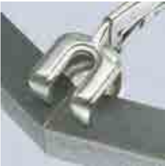
42 14 280 耐热展性铸铁钳口；在焊接时能牢固夹持并排放置的型材或扁平材料；型材最大垂直厚度可达25mm
