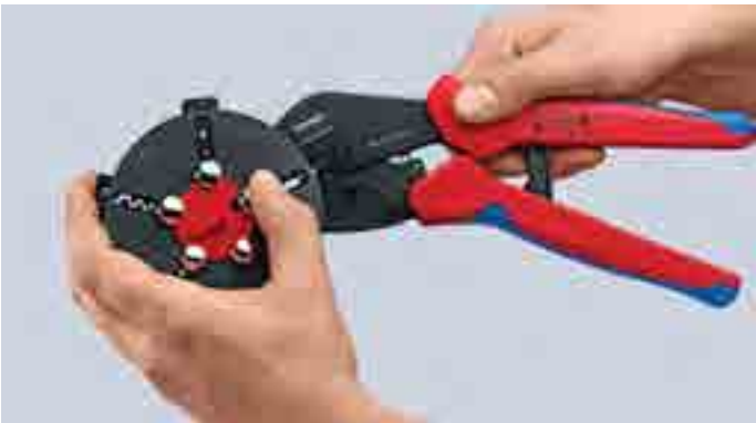
步骤2：钳口插入模具盘，打开锁定开关，从模具盘里拔出已经装配到位的模具
