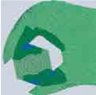
钳式扳手：压力状态下无间隙，对工件表面无损伤
