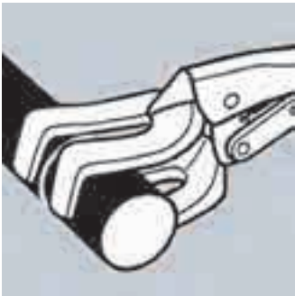
42 24 280 耐热展性铸铁钳口；焊接时，能牢固夹持并排放置的型材或扁平物料
