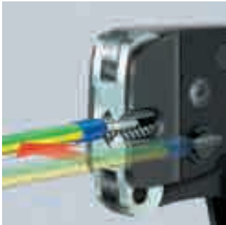
2.5mm²及以下规格可以从侧前方平移进线
