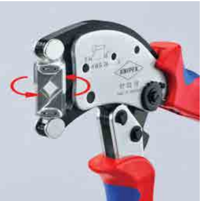
压接模块能够360° 旋转，以调整至合适的压接位置，即使是相当有限的空间内 不用调节也能够轻松压接双线套管端子，最大2 x 6mm 2
