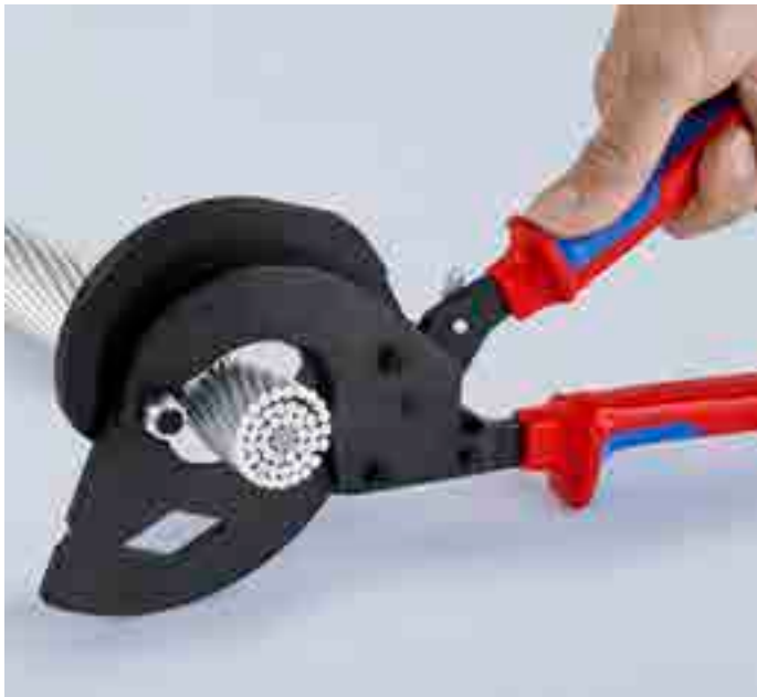
当剪切大直径线缆时，可将一侧手柄上凸出部位作为剪切支撑点。
