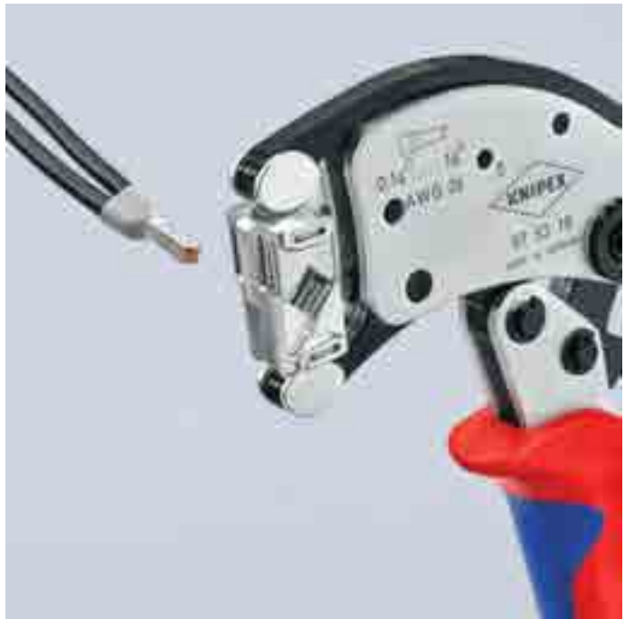
压接模块能够360° 旋转，以调整至合适的压接位置，即使是相当有限的空间内 不用调节也能够轻松压接双线套管端子，最大2 x 6mm 2
