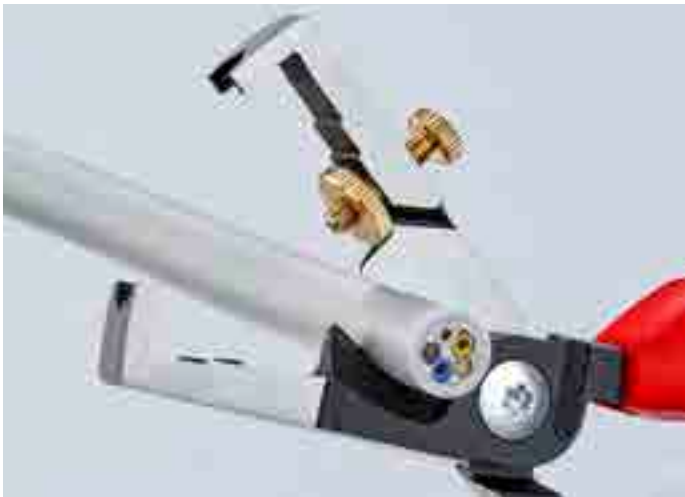
感应淬火的电缆刀片带圆切刃，剪切铜电缆最大直径Ø 15 mm (5 x 2.5 mm²)，无毛刺。
