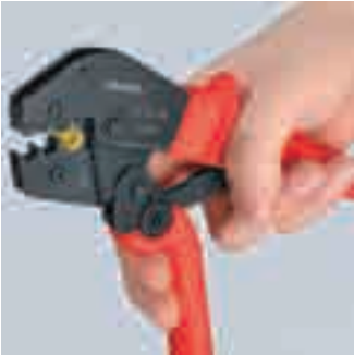
步骤1：用两个手指拉动手柄，至端子定位即可
