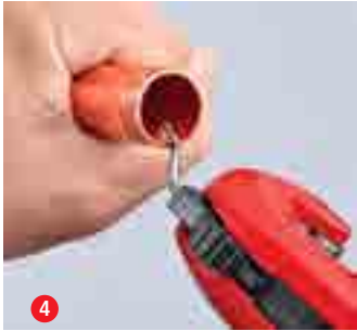
随后操作就完成了！如有必要，使用折叠式去毛刺工具将切割边缘磨平——只需要一点力度即可
