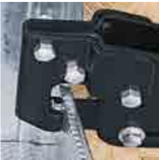
将钳子放置到两块金属板的连接处
