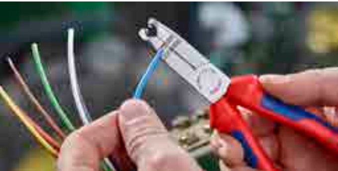
剥线孔用于1.5mm²和2.5mm²的导线
