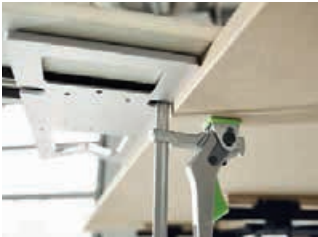
精确 90° 切割 利用螺旋夹具将角度靠尺固定在工件上。
