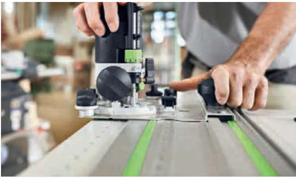
在家具制造中必不可少 铣机和带排孔的导轨方便书架/搁板家具或者五金件的加工。
