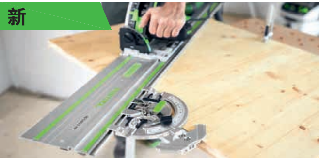
角度靠尺确保精准调节 -60 至 +60 度的角度切割，精准而便捷：快速而方便的调节，令角度切割得以准确进行。常用角度调节的规定卡止点令高精度加工轻松实现。
