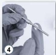
■ 在枪针接触密封圈的位置 涂少许润滑油
