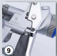
■ 在扳机顶杆的可见部分涂 少许润滑油
