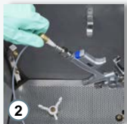
■ 把洗枪机空气接头插进喷枪进风口
