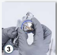
■ 安装风帽以令上面的标识 可以正确阅读
