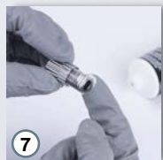
■ 在涂料流量调节旋钮的螺 纹上涂少许润滑油
