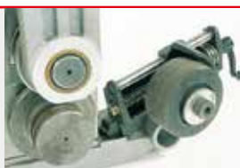
短管稳定器（59992）在对短管或接头进行滚沟时更轻松
