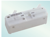
SMD测试治具 9677 直接连接型, 侧面有电极的 SMD专用, DC~120MHz, 被测物尺寸: 3.5±0.5mm
