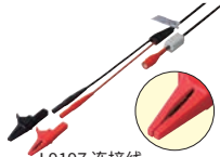
L9197 连接线 最大可输入600V, 线径φ5.0mm, 线长1.8m, 标配可脱卸大型鳄鱼夹
