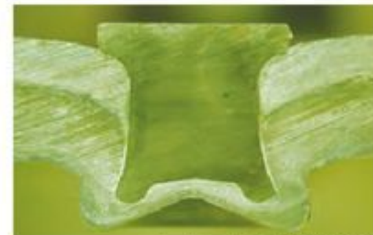
ホールレスリベット締結(断面図)
