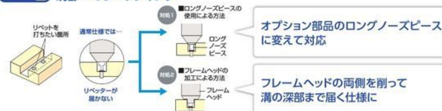
●フレームヘッドの先端のみの加工例
