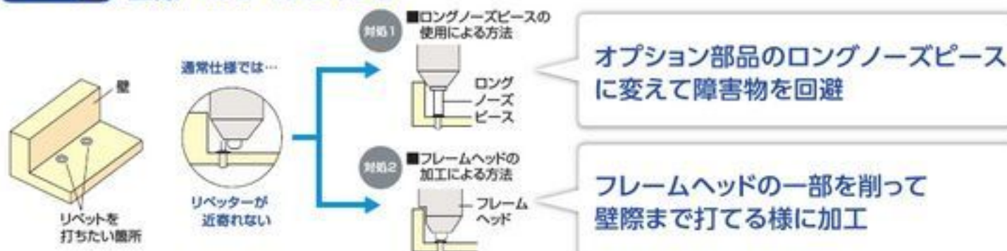
●フレームヘッドの加工例
