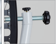
ハブ支持軸の固定ノブセンターゲージを当てるために、ホイールを取り外しても接触子の位置が変わりません(左右どちらにでも取り付け可能)
