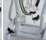
市販のダイヤルゲージを取り付け可能(取り付け用の耳金がついているものに限り)
