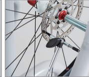
ディスクローターの歪み検査も可能
