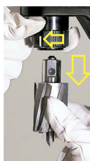
刀具卸载 刃物の取り外し
