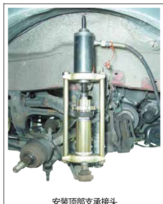
安装顶部支承接头
