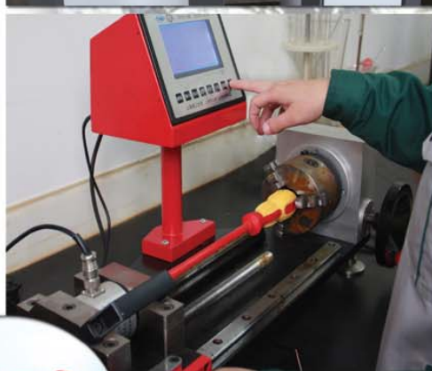
防爆螺丝刀检测现场
