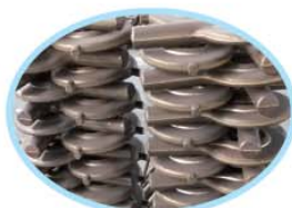
待机械加工的模锻防爆手拉葫芦上下吊钩半成品件
