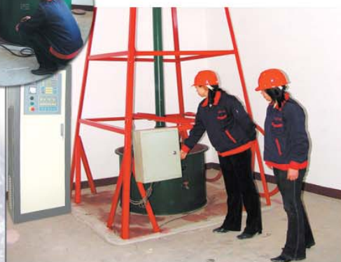
公司防爆工具材料落锤性能检测现场
